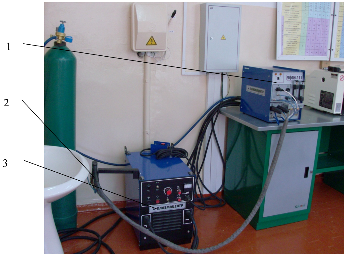
Рисунок 2 – Установка для финишного плазменного упрочнения
