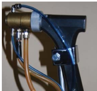
Рис. 2. Общий вид плазматрона с плазмохимическим реактором.
