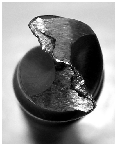
Рисунок 4 – Деформация рабочей части сверла в результате ослабления силы его закрепления
