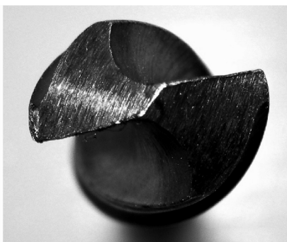
Рисунок 3 – Износ режущих кромок сверл: а – не подвергнутого ФПУ; б – подвергнутого ФПУ
