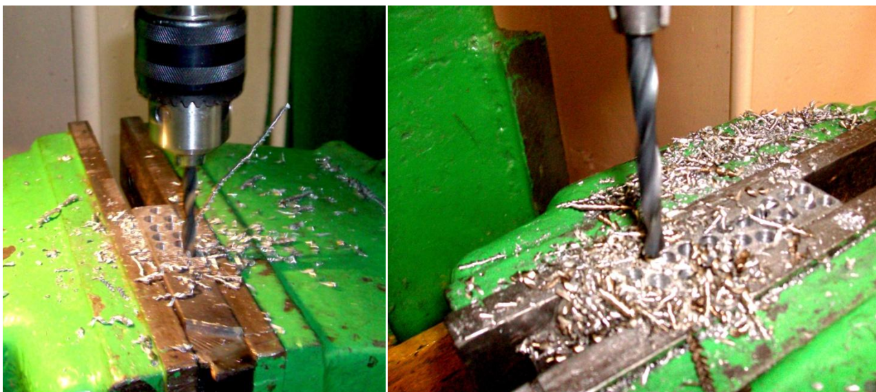
Рисунок 2 – Сверление отверстий в пластине: а) сверло, подвергнутое ФПУ, б) сверло, изготовленное по обычной технологии
