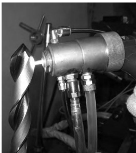
Рис. 8. Нанесение износостойкого покрытия системы Si—O—C—N методом финишного плазменного упрочнения
