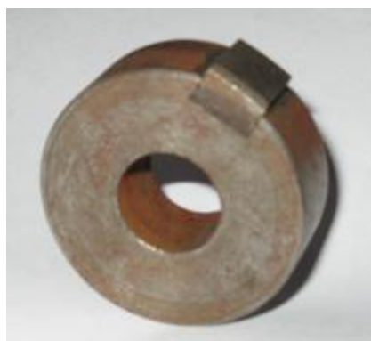
Рис. 2. Ролик с образцом, вырезанным из поршневого кольца
