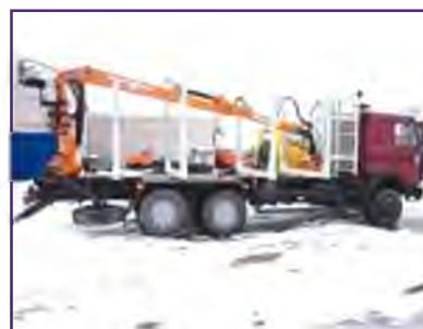
Рис. 2. Сортиментовоз на шасси МАЗ 6303А5 с гидроманипулятором СФ 65С.
