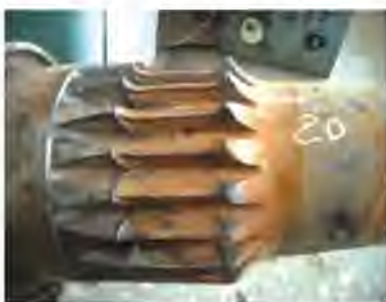
Рис. 1. Износ зубьев шестерни поворота колонны гидроманипулятора.
